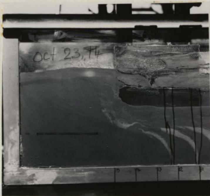
FIG. 73.- PHOTOGRAPH SHOWING THE SOIL FAILURE IN FRONT OF THE 2" WIDE MODEL WITH ROUNDED TOE
