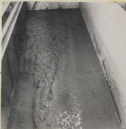
FIG. 62.- PHOTOGRAPH OF THE SOIL FLOW AROUND A LABORATORY GOUGE TRACK
