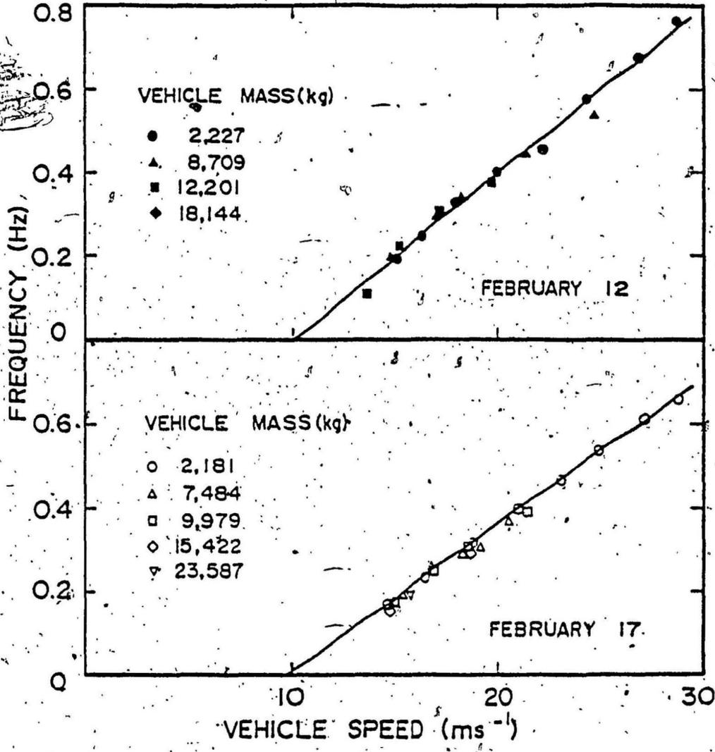
FIGURE 4 FREQUENCY VERSUS VEHICLE SPEED (EYRE, 1977)
