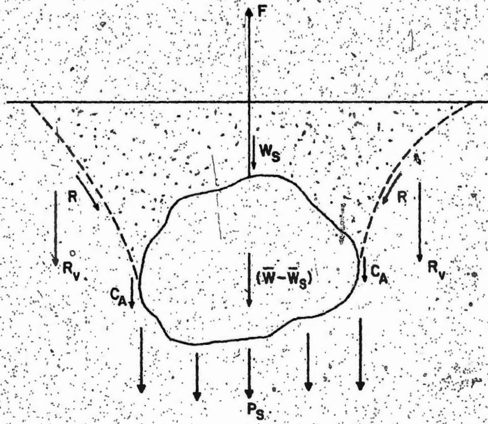
Fig. 1 MECHANICS OF BREAKOUT
