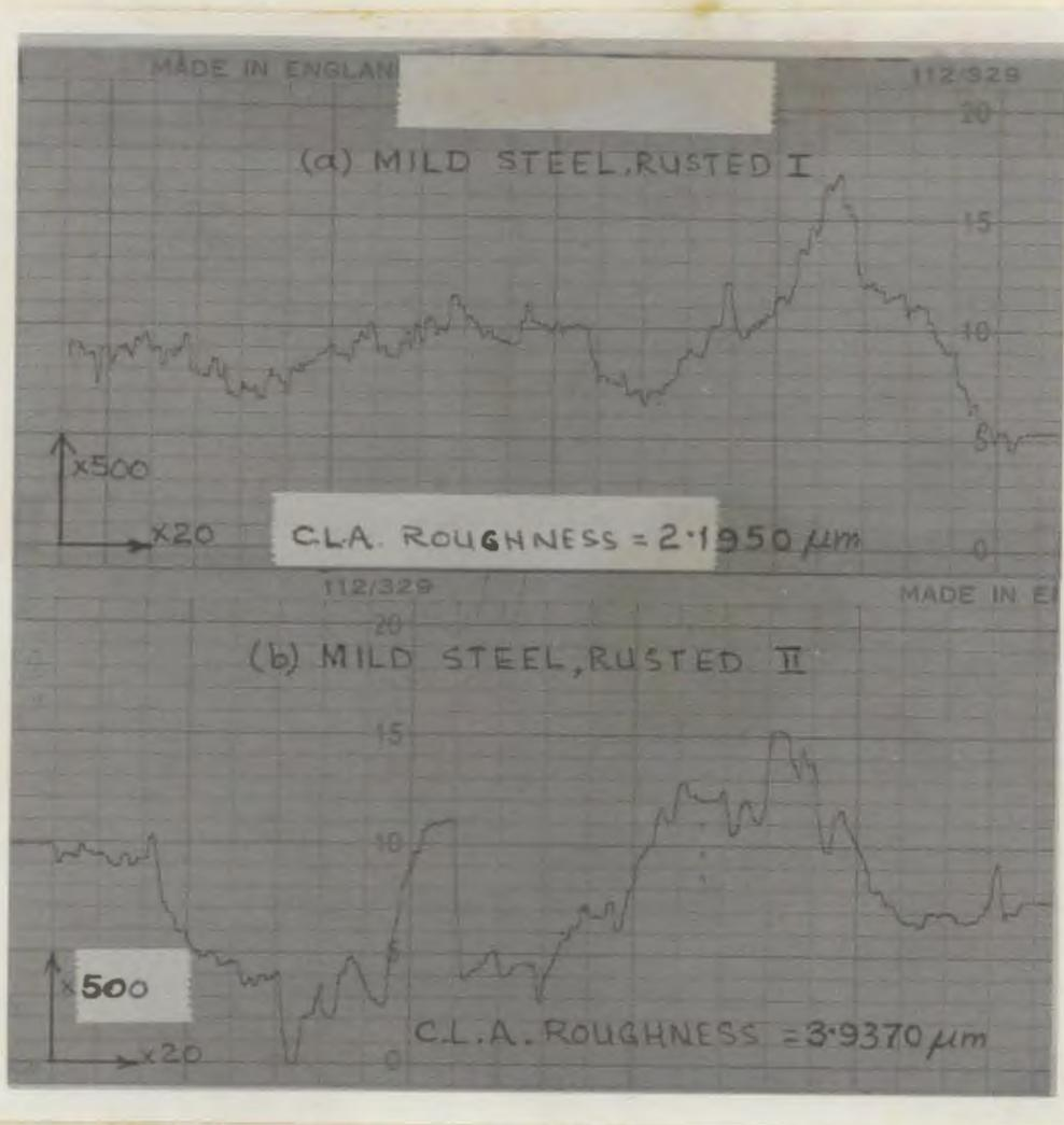
Fig. 19 SURFACE ROUGHNESS OF (a) MILD STEEL RUSTED I, and
