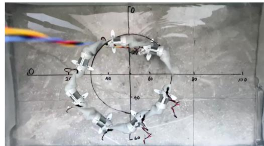
(d) Swing Amplitude  $30^\circ$ , counter-clockwise
