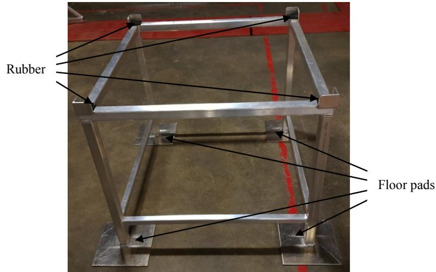
Fig. 6.7: Stand used underneath the fan
