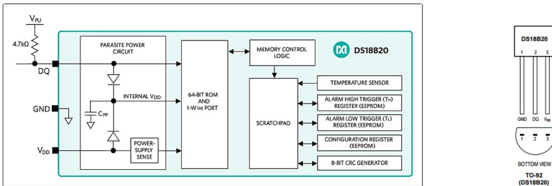
Figure 5.4 Block Diagram of the DS18b20 and Pin-outs
