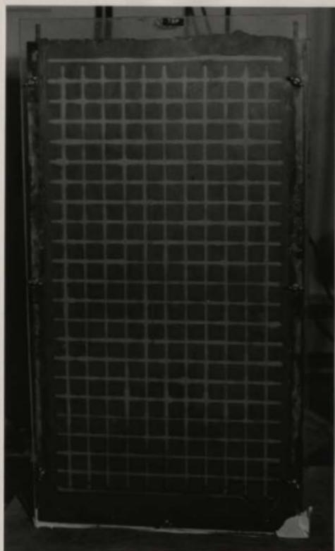
FIG 14 FORMATION OF 1 IN. GRID ON MUD SAMPLE
