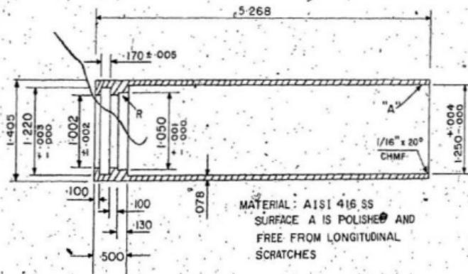
FIG. B3 FRICTION SLEEVE
